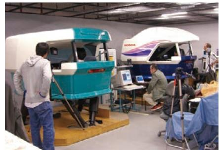
複数ドライビングシミュレータを用いた走行模擬実験
