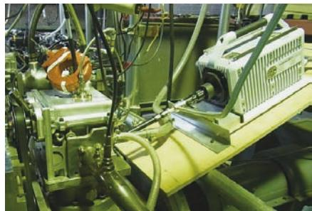
ガソリンエンジンの燃焼解析：エンドスコープによるエンジンシリンダ内の燃焼観察
