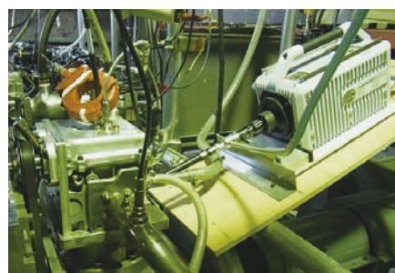
ガソリンエンジンの燃焼解析：エンドスコープによるエンジンシリンダ内の燃焼観察
