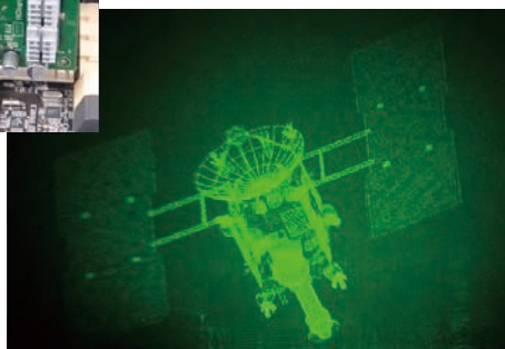
三次元映像技術ホログラフィを電子的に利用した三次元テレビの研究：左段は研究室で開発した専用コンピュータボードで、右段は人工衛星の三次元動画像のワンショットです。
