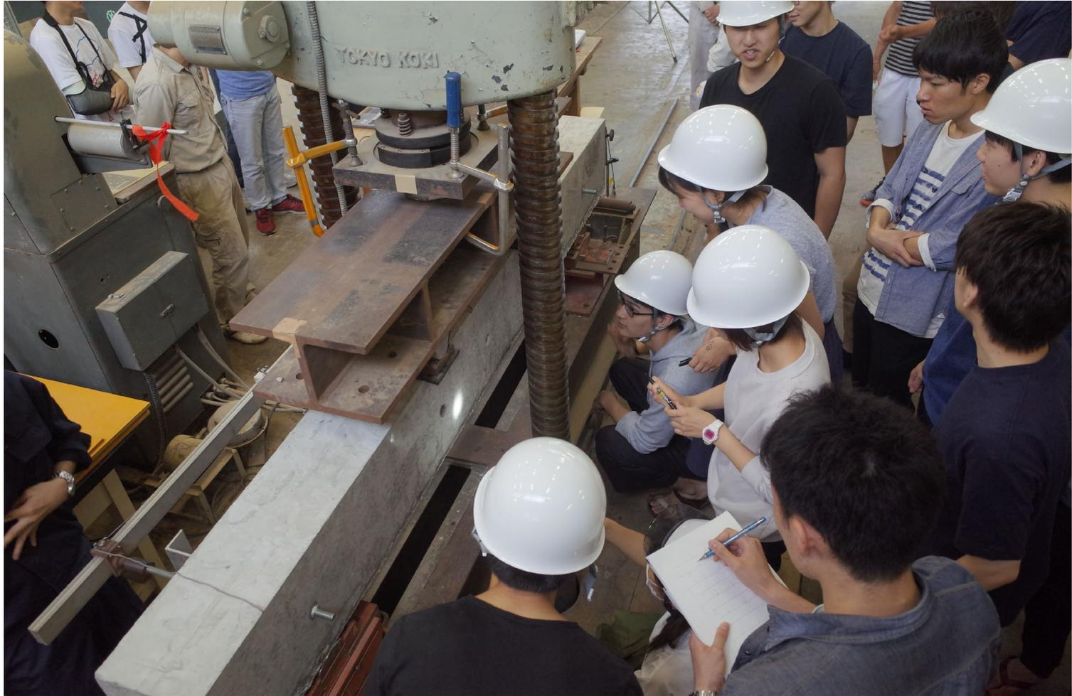
梁を自作し壊してみても、構造の勘所を知る：材料・構造実験（3年生の授業）
